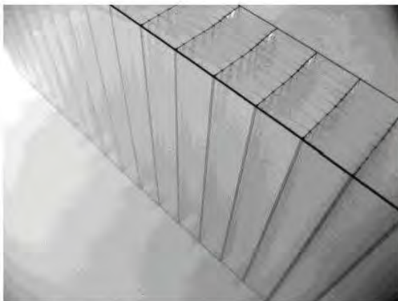
9-Kammer Polycarbonatplatte mit U = 0,83 \text{ W/m}^2\text{K}
