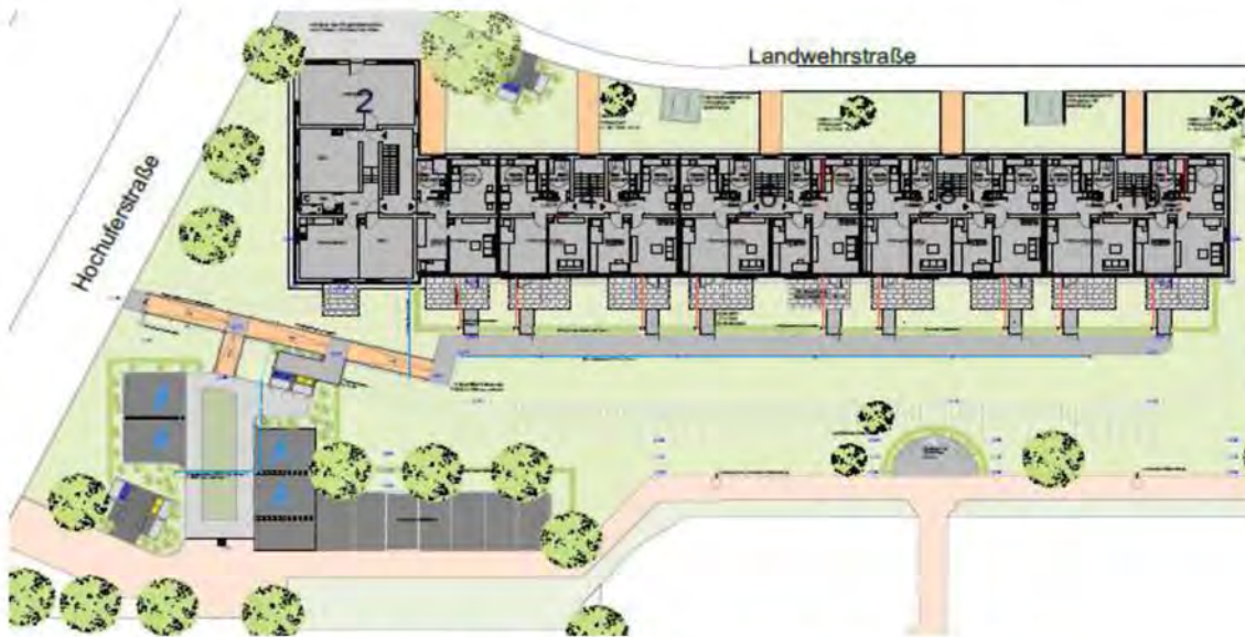
Barrierefreier Zugang durch Geländemodellierung mit integrierter Rampe
